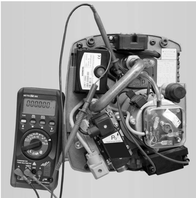
Abb. 22: Messgerät Ionisationsstrom
