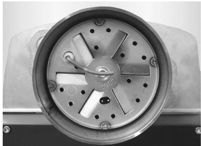
Abb. 19: Position Ionisationselektrode
